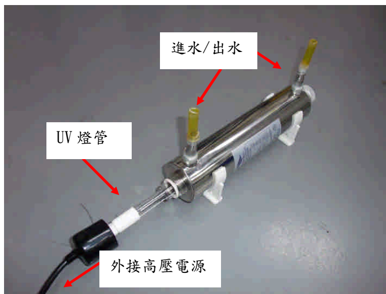
圖 4.10 常見紫外燈殺菌設備之構造
