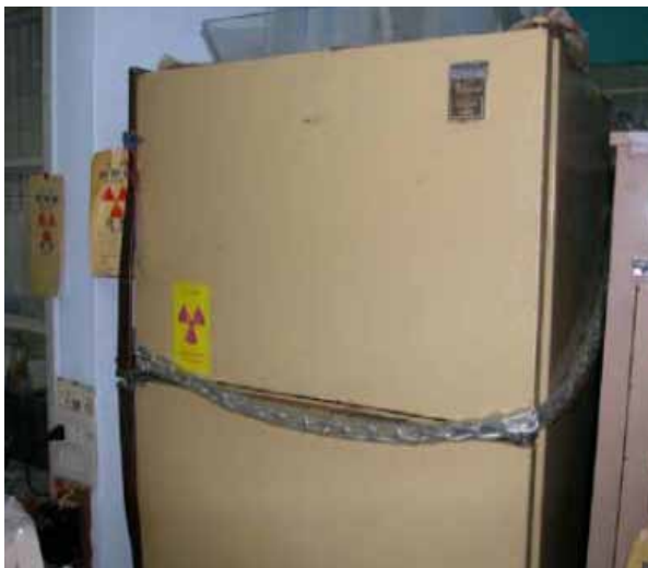
圖三、非密封放射性物質儲存冰箱以鎖鏈上鎖。
